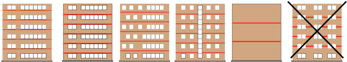
Joonis 12. Fassaadi läbivate tuletõkestite asukohad.
